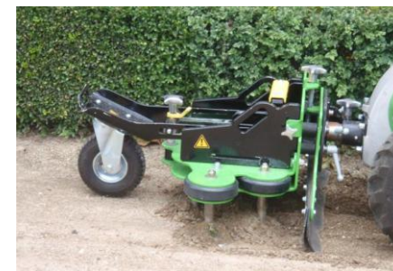
Désherbage mécanique à disques horizontaux sur motoculteur
